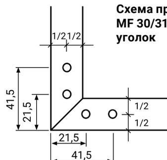
Для расчета размеров наполнения (стекло 4 мм) используется следующая формула: габарит фасада минус 7 мм. При использовании профиль-ручки MF 32 для расчета размеров наполнения (стекло 4 мм) применяется следующая формула: по высоте минус 7 мм, по ширине минус 29 мм.
